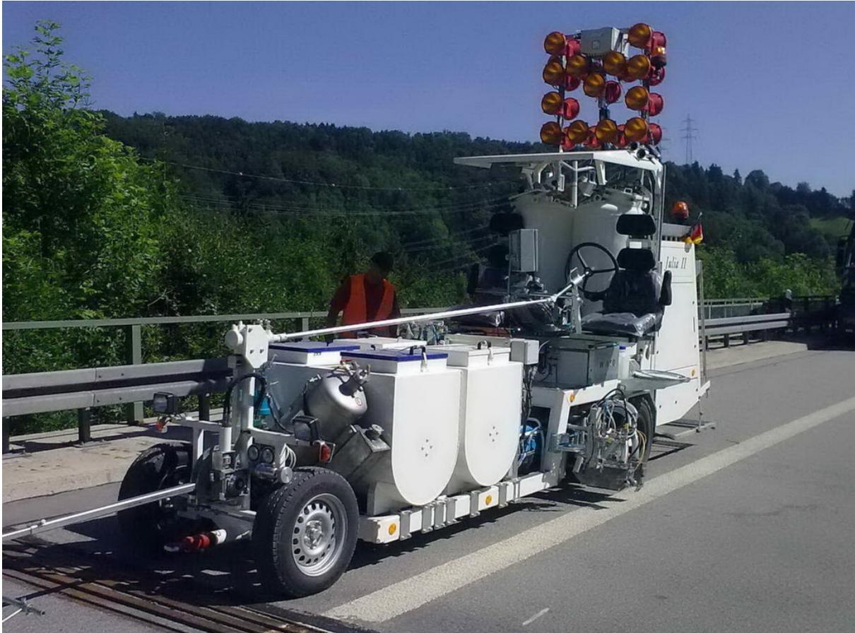
**Машина дорожной разметки для холодного распыляемого пластика**
