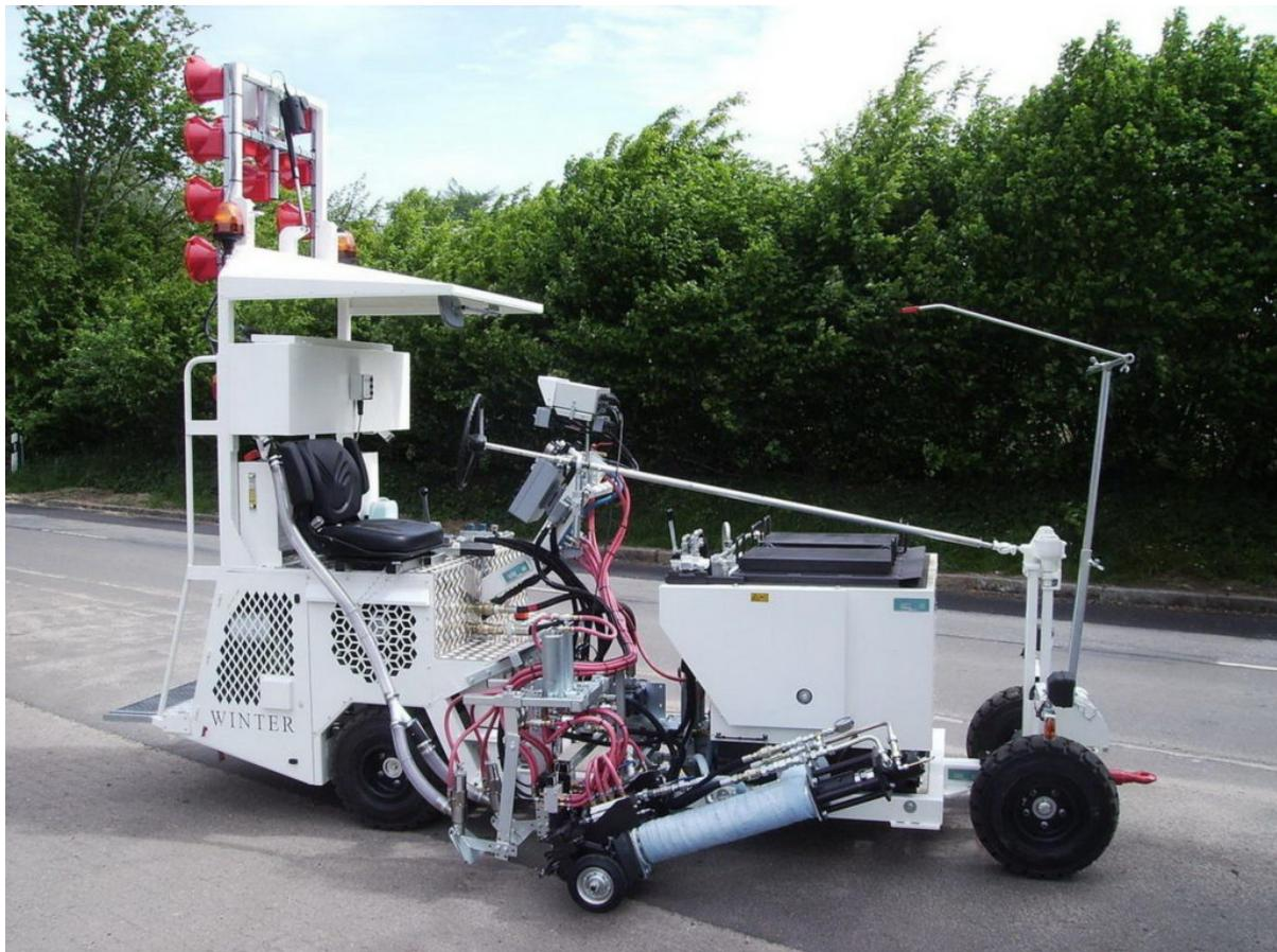
**Машина дорожной разметки для термопластика с экструдером**
