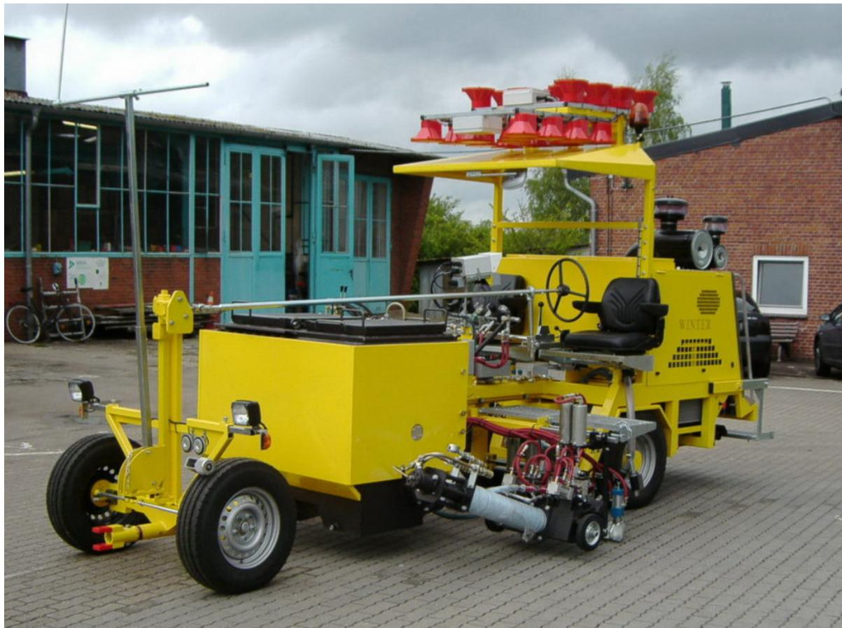
**Машина дорожной разметки для термопластика с экструдером**
