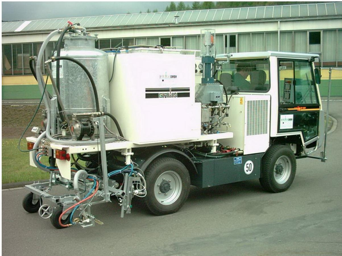
**Машина дорожной разметки на базе грузовых автомобилей**
