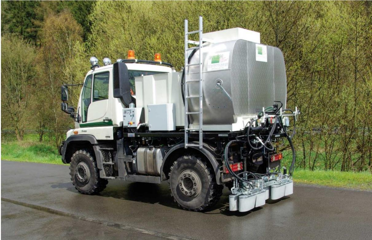
**Bitumenspritzaufbauten werden nach Kundenvorgaben gefertigt.**
